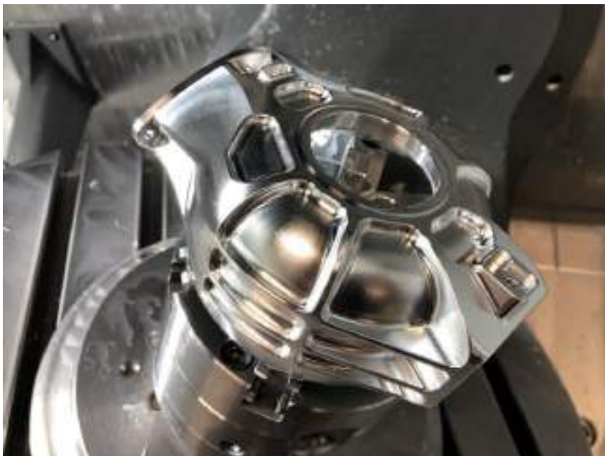
Деталь від нашого клієнта, чорнова обробка поверхні здійснена за допомогою модуля Авто 3+2 THSR , чистова обробка за допомогою модуля HSS
