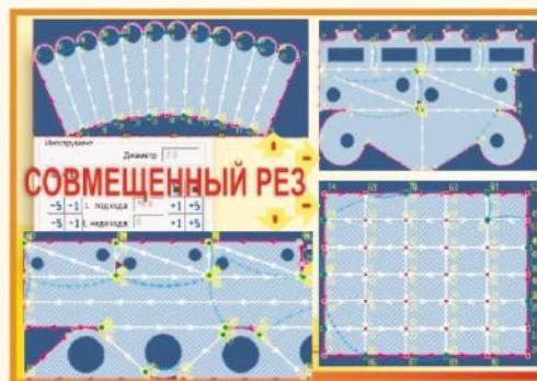
**НЕПРЕРЫВНЫЙ РЕЗ** обход контуров нескольких деталей с одной точкой пробивки без выключения резки. Значительная экономия времени на пробивку и расход вспомогат. материалов.
