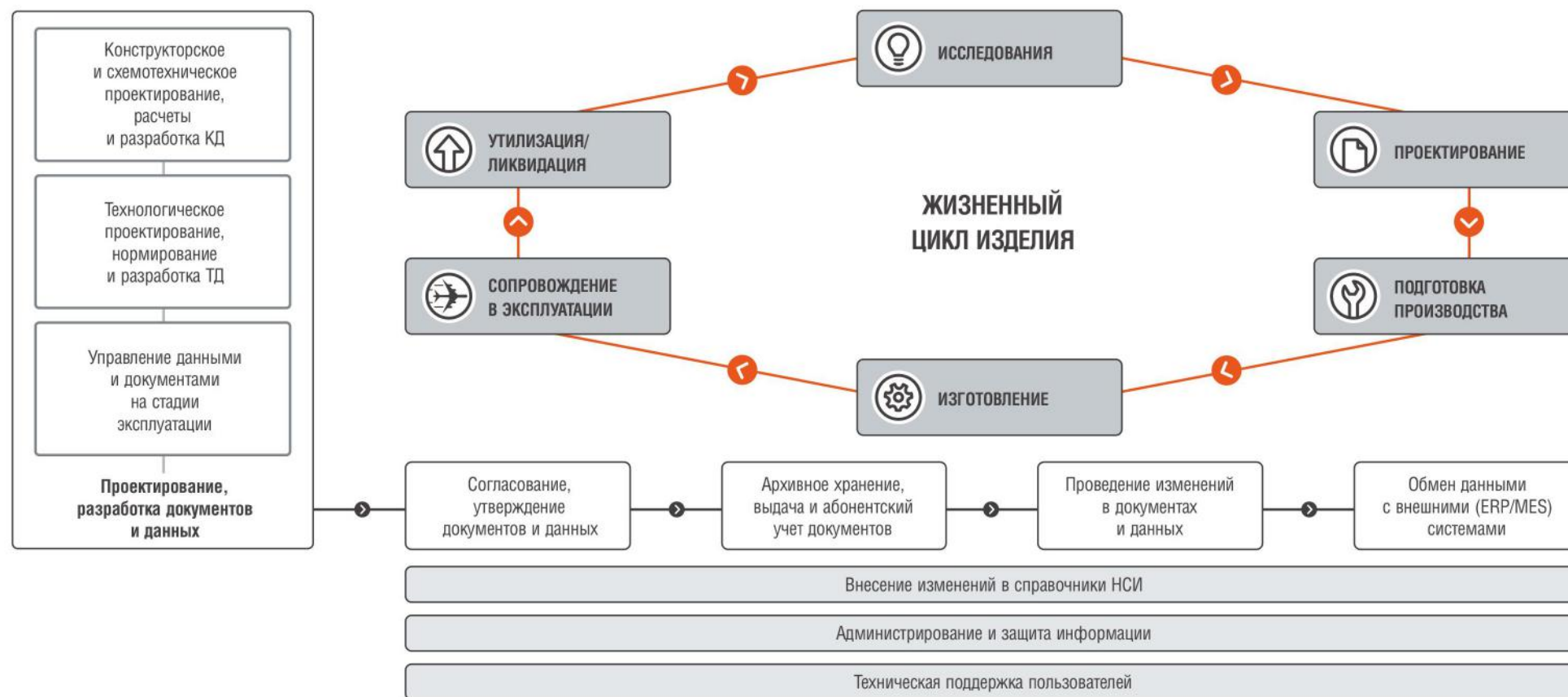
Процессная модель сквозной 3D-технологии
